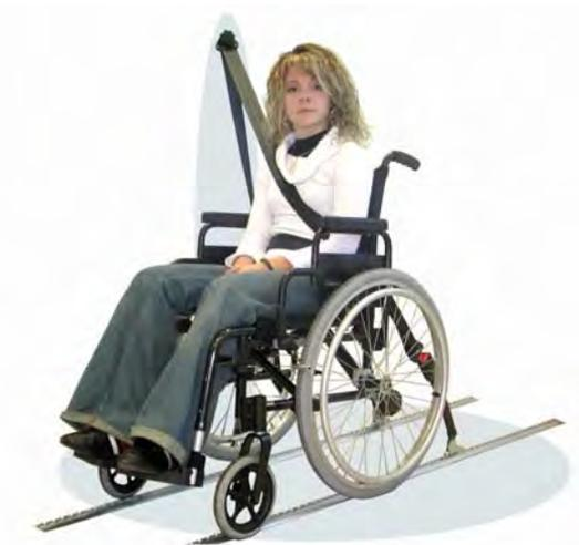
Sujeción del pasajero en silla de ruedas. El cinturón sujeta la persona mediante tres puntos dos en el suelo y uno en el lateral por encima del hombro.
